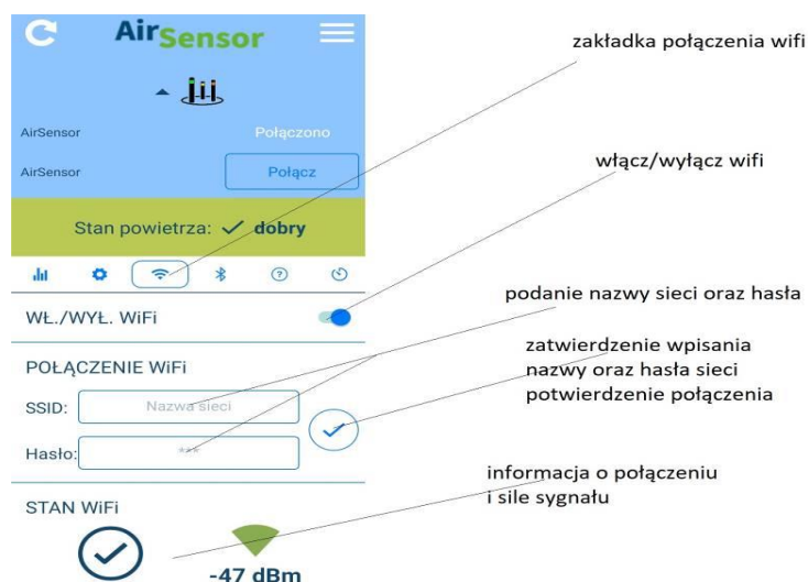
rys. 41 AirSensor - zakładka połączenie WiFi (wersja rozszerzona)
